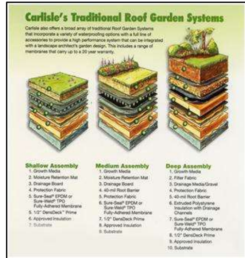
Gambar 9. Pemanfaatan atap sebagai roof top garden (kiri) dan detail Carlisle traditional roof garden systems
